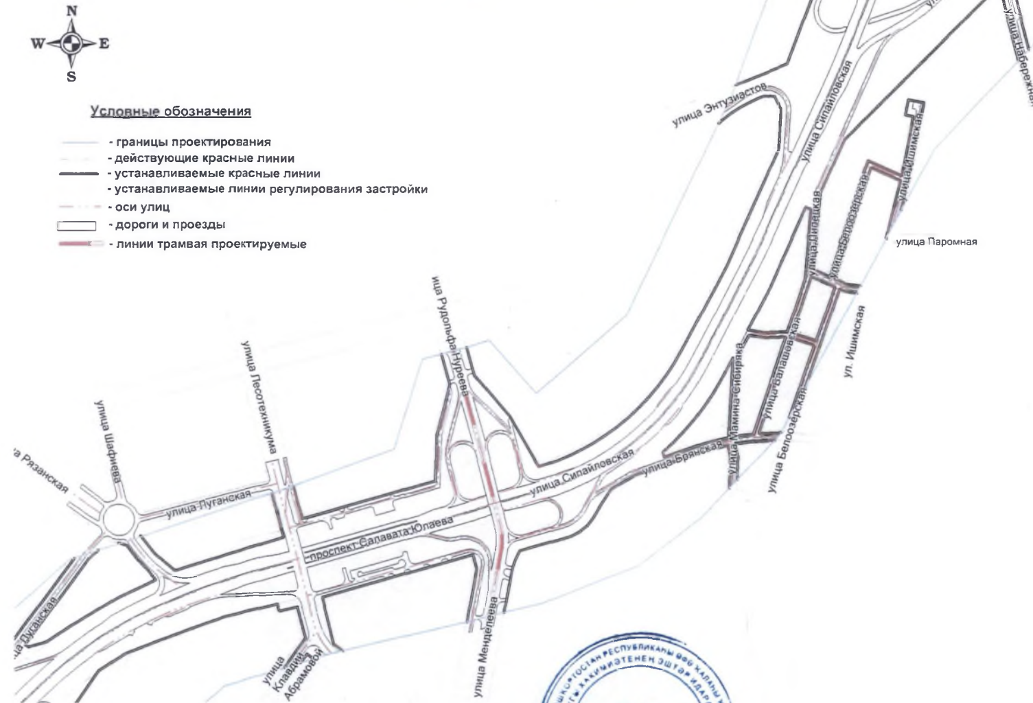
Чертеж планировки территории с отображением красных линий, линий регулирования застройки, осей улиц, линий дорог и проездов Лист 6. (согласно приложению 1.1)
