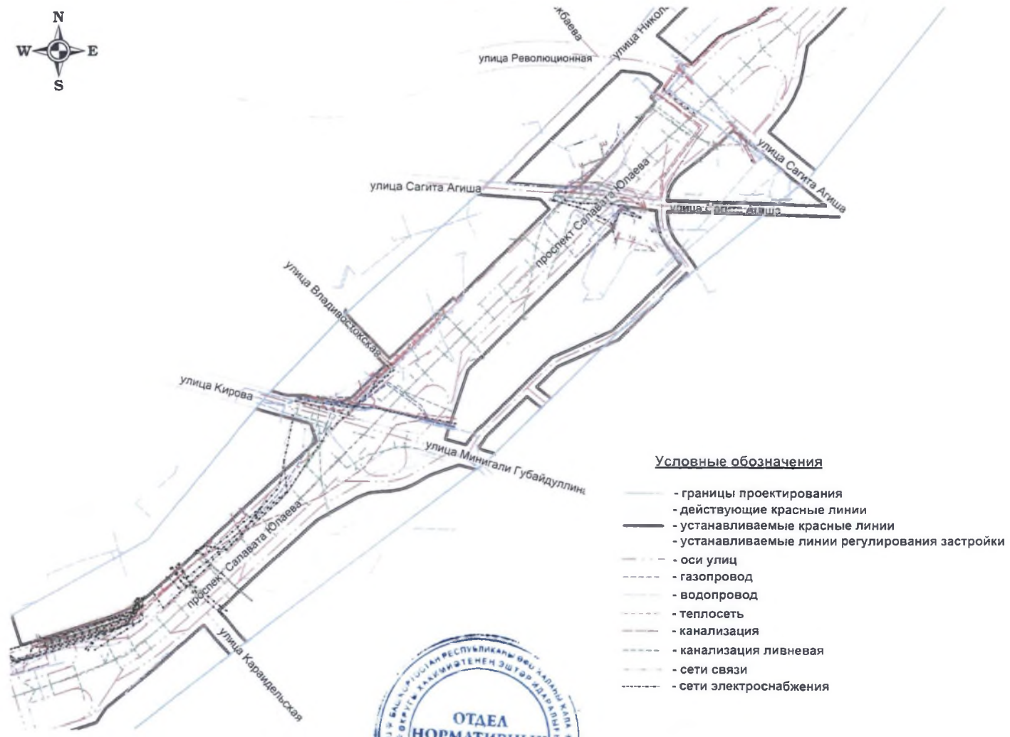
Чертеж планировки территории с отображением красных линий и объектов инженерной инфраструктуры Лист 3. (согласно приложению 2.1)
