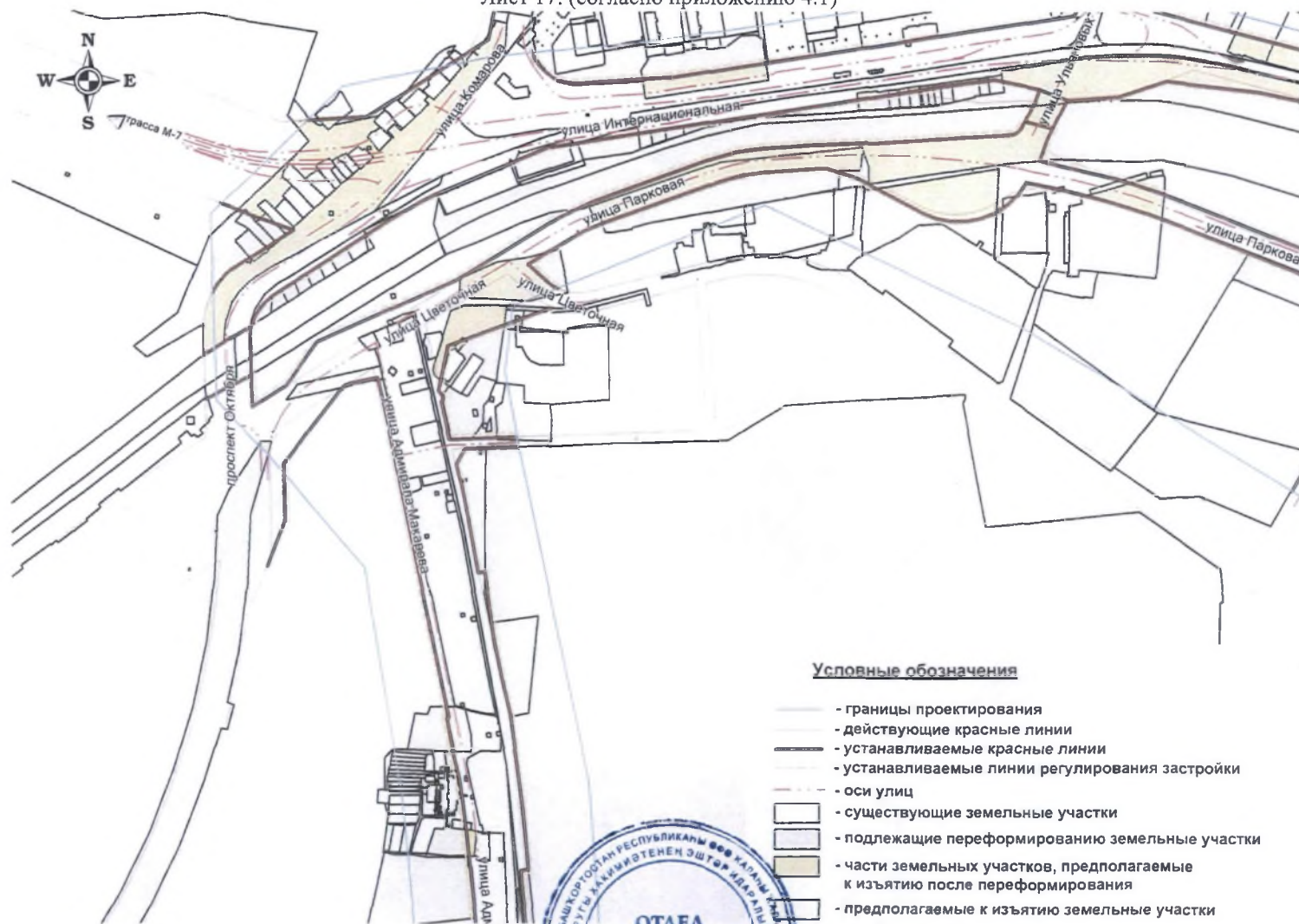
Чертеж межевания территории с отображением красных линий, линий регулирования застройки, границ земельных участков Лист 17. (согласно приложению 4.1)
