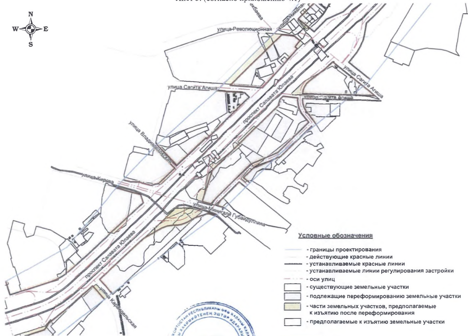
Чертеж межевания территории с отображением красных линий, линий регулирования застройки, границ земельных участков Лист 3. (согласно приложению 4.1)
