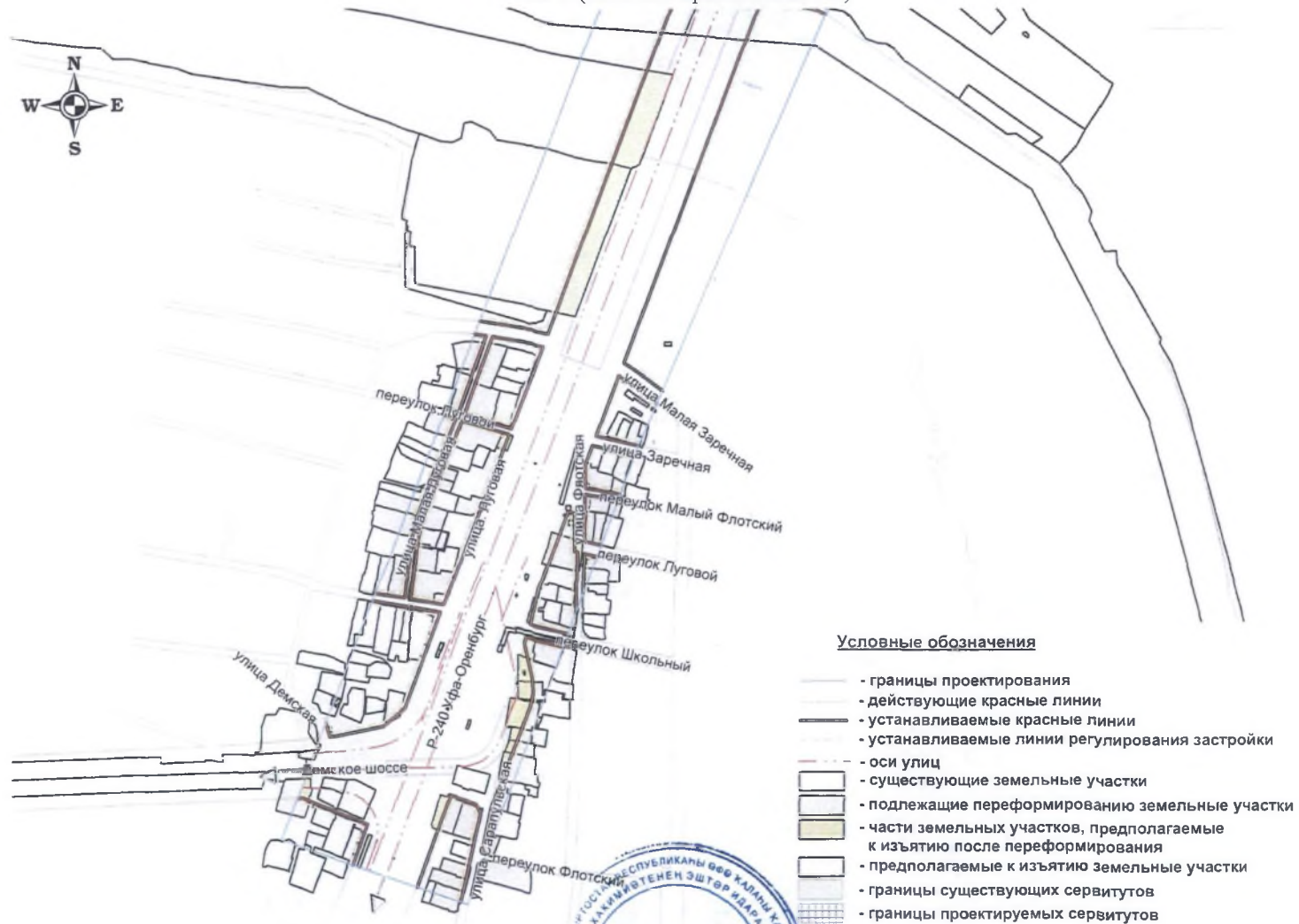
Чертеж межевания территории с отображением красных линий, линий регулирования застройки, границ зон действия публичных сервитутов Лист 1. (согласно приложению 5.1)
