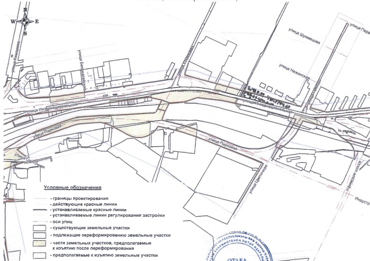
Чертеж межевания территории с отображением красных линий, линий регулирования застройки, границ земельных участков Лист 16. (согласно приложению 4.1)
