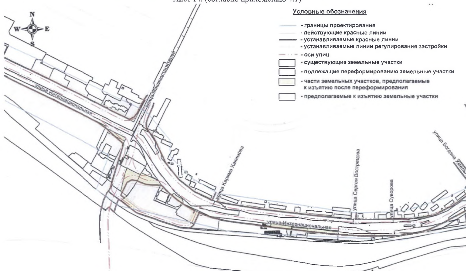
Чертеж межевания территории с отображением красных линий, линий регулирования застройки, границ земельных участков Лист 14. (согласно приложению 4.1)
