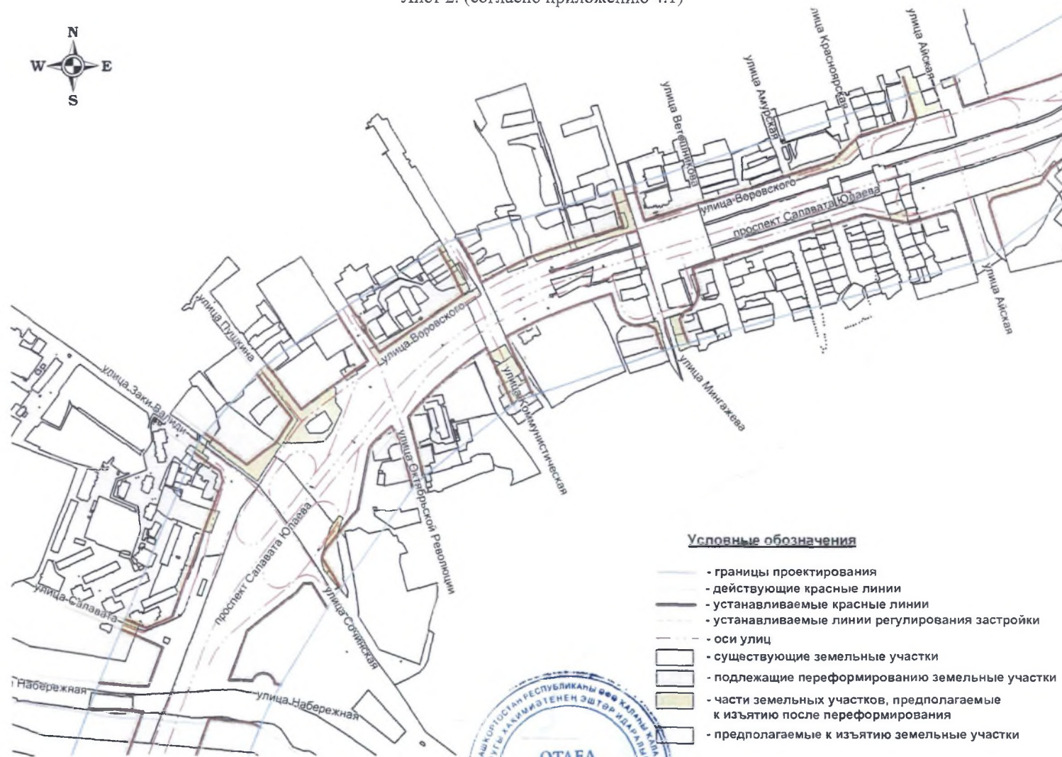
Чертеж межевания территории с отображением красных линий, линий регулирования застройки, границ земельных участков Лист 2. (согласно приложению 4.1)
