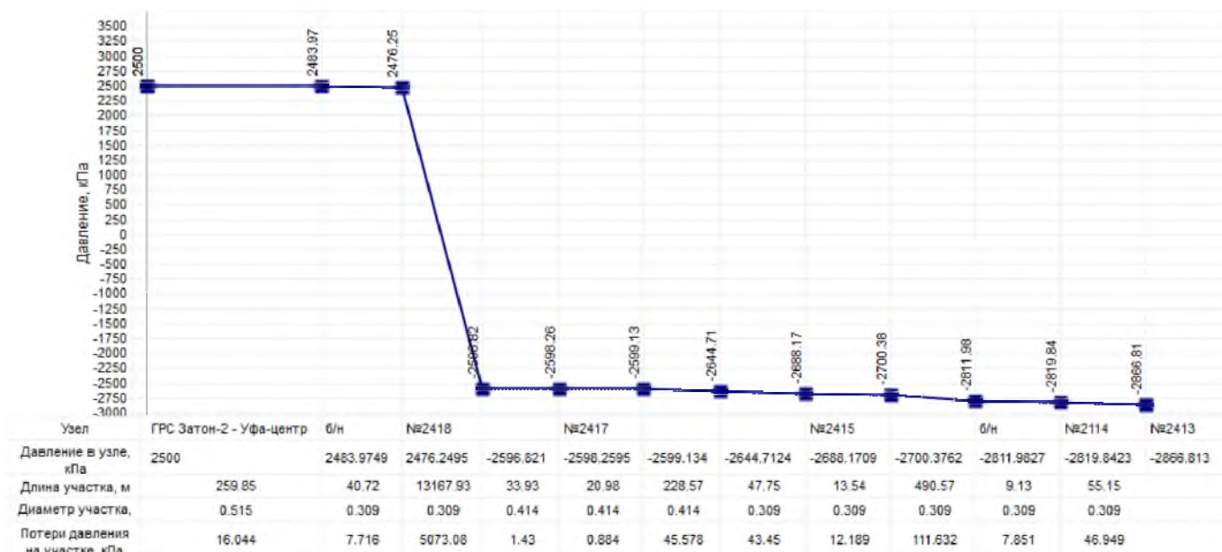
Рисунок 100 Пьезометрический график участка ГРС Затон-2 – ГГРП Уфа
